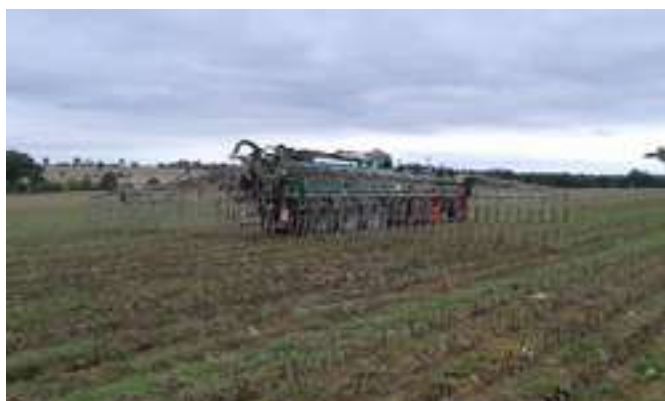
PHOTO 6/ Épandage par rampe à pendillards
