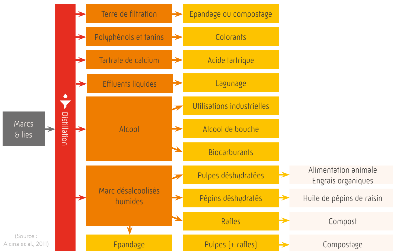
FIGURE 11/ Schéma d'organisation d'une distillerie
