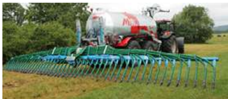
PHOTO 9/ Rampes à patins
