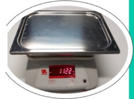
Photo 2 : Un Bac inox GN \frac{1}{2} (dim 32,5 x 25,6 cm ; poids 1 122 g)
