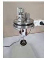
Calorimètre avec sa bombe calorimétrique ○ Analyse des différents pouvoirs calorifiques (supérieur et inférieur)
